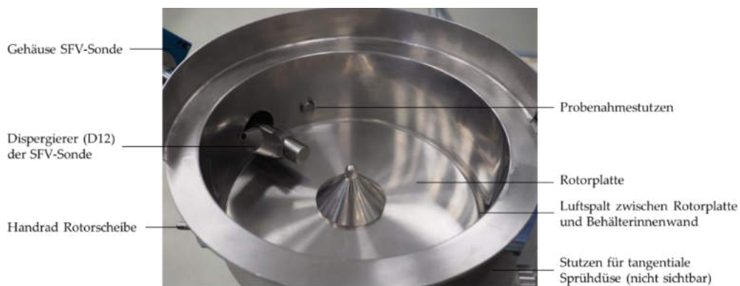
Abbildung 3.8: Innenaufnahme des Materialbehälters vom Rotoreinsatz der Wirbelschichtanlage GPCG 1.1 der Glatt GmbH. Eigenaufnahme vom 09.09.2019.
