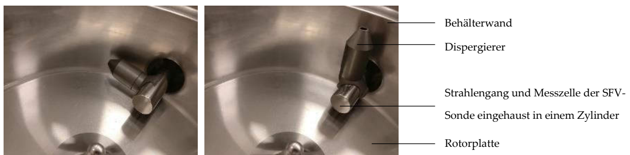
Abbildung 3.11: Dispergierer der Sonde im 0° und 90° Winkel. Eigenaufnahme vom 09.09.2019.
