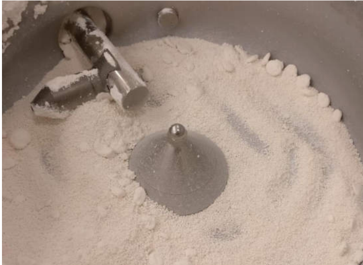
Abbildung 4.45: Grobe Agglomerate am Prozessende nach Coating in der Rotor-Wirbelschicht auf Grund einer zu hohen Produktfeuchte während der Agglomeration/Pelletierung (Charge RAC_20). Eigenaufnahme vom 17.07.2020.
