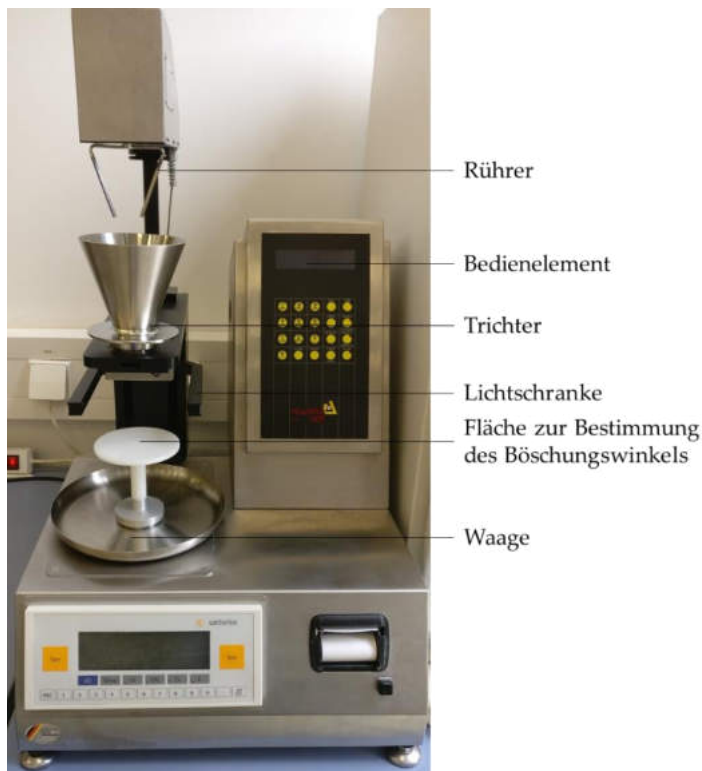
Abbildung 3.13: Fließmessgerät PTG-S4 der Firma Pharmatest AG. Eigenaufnahme vom 17.07.2020.
