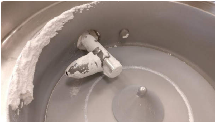
Abbildung 4.42: Produktanhaftungen an Behälterwand und Sonde (Charge Ausr_2, Natriumbenzoat-Rezeptur). Eigenaufnahme vom 03.04.2020.
