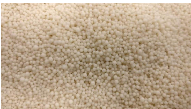
Abbildung 4.37: Mikrofoto (Stereomikroskop) von Pellets aus MCC/Wasser, Charge 3, Rotor-Wirbelschicht. Eigenaufnahme vom 05.02.2020.
