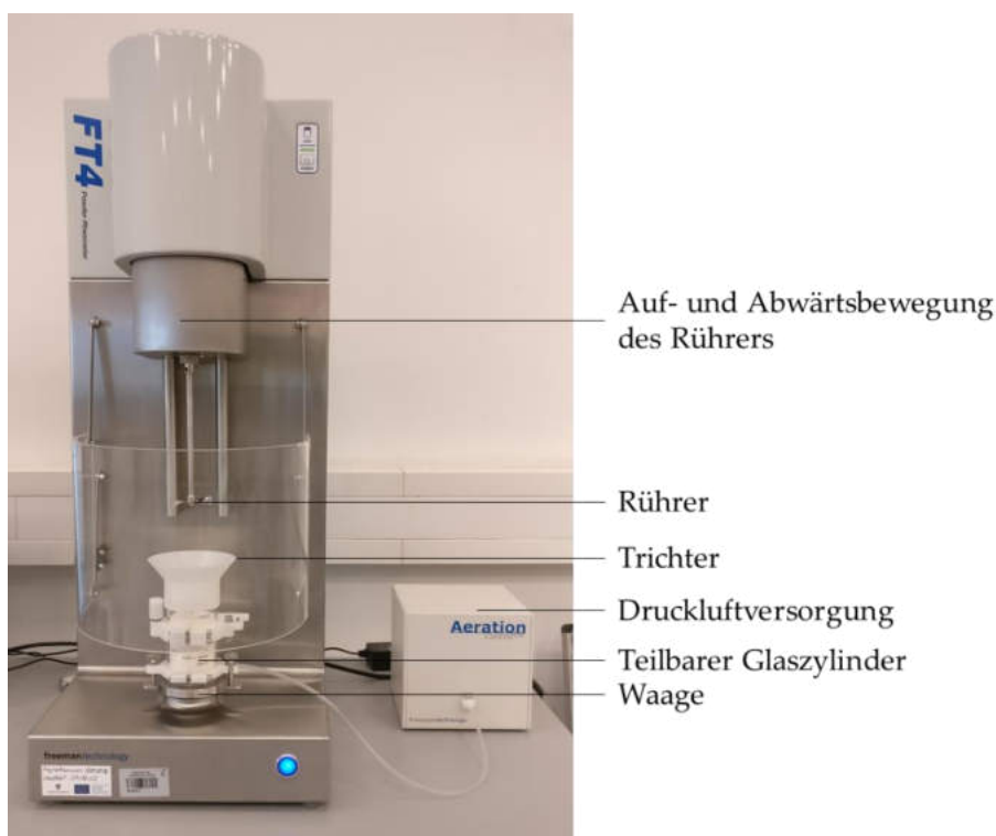
Abbildung 3.15: Pulverrheometer FT4 der Freeman Technology Ltd. Eigenaufnahme vom 11.08.2020.
