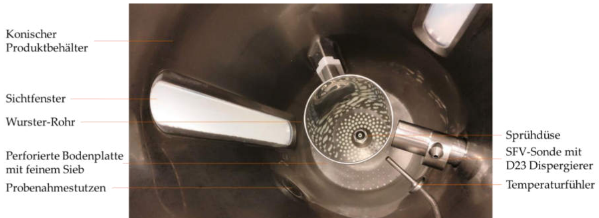
Abbildung 3.6: Innenaufnahme des Materialbehälters mit Wurster-Einsatz der Wirbelschichtanlage GPCG 1.1 der Glatt GmbH. Eigenaufnahme vom 02.07.2020.
