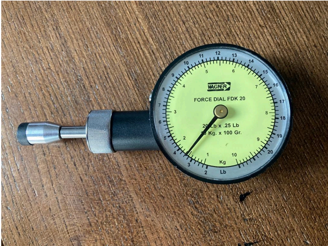
Abb. 2: Algesiometer (FIRMA WAGNER INSTRUMENTS, Greenwich, Connecticut 06836, USA) zur Bestimmung der Schmerzschwelle (mechanische Schmerzschwelle).
