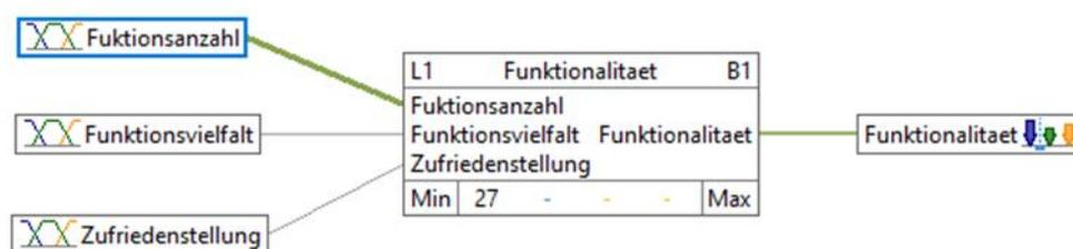
**Abbildung 42: Prozessdiagramm einer Fuzzy-Aggregation am Beispiel der Funktionalität**
