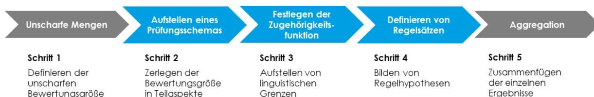
**Abbildung 36: Struktur eines Fuzzy-Expertensystems**
