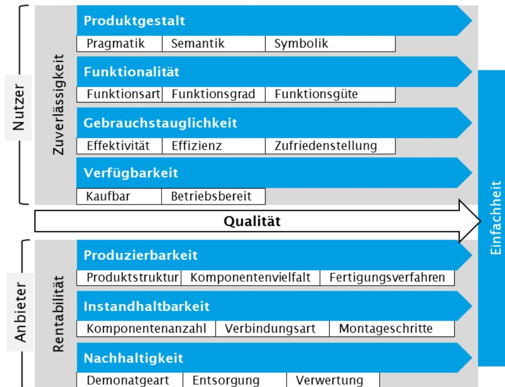
**Abbildung 29: Attribute des IDE zur Definition des Leistungsangebots einfacher Produkte mit Erweiterung von Unterkriterien nach [PiVS-2018a]**
