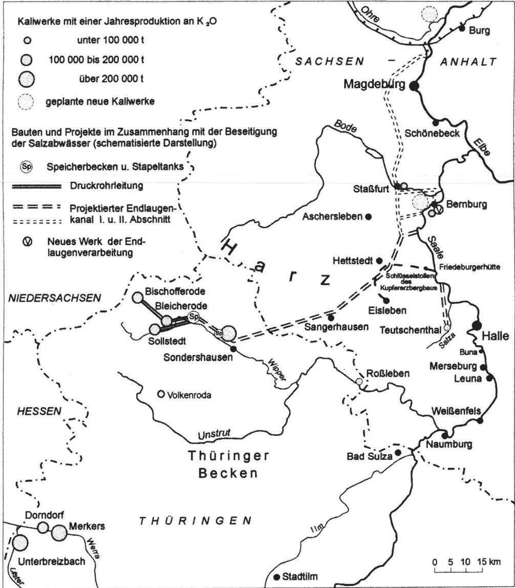
Abb. 1: Verlauf des vorgesehenen Kanales zur Ableitung der Kaliendlaugen aus den Kaliwerken des Südharz-Revieres und des Saale-Bode-Revieres (vereinfacht nach KOHL 1966)
