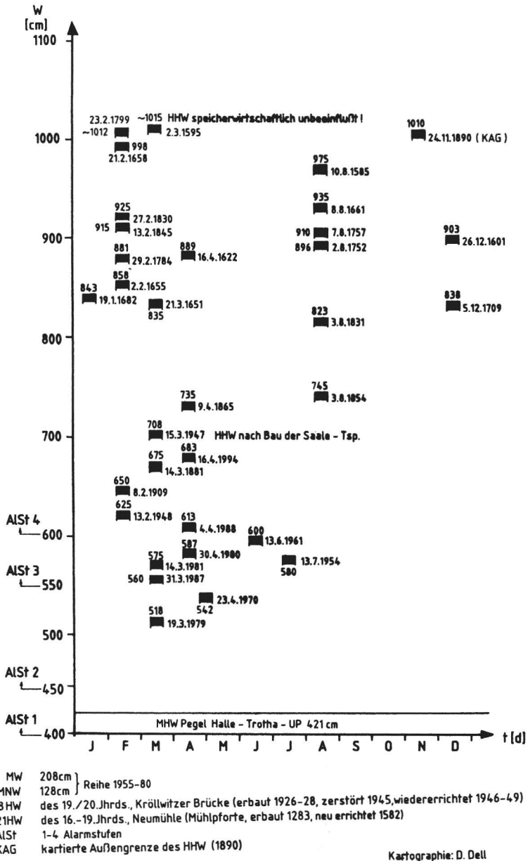
Abb. 3: Übersicht über die wichtigsten historischen Saale-Hochwässer bezogen auf den Pegel Halle-Trotha (Unterpegel)
