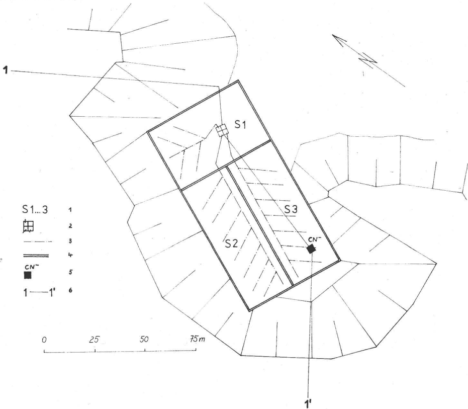
Abb. 1. Versuchsdeponie – Aufsicht. 1 Segmente der Versuchsdeponie, 2 Kontroll- und Entwässerungsschacht, 3 Drainagen, 4 wallartige Umrandung der Versuchsfläche und der einzelnen Segmente, 5 Härtesalzablagerungsstandort, 6 Spur des geologischen Schnittes, CN - -Ablagerung im S2 analog wie im S3 eingezeichnet.
