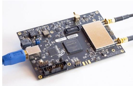
Abbildung 1 Darstellung des bladeRF [2]
