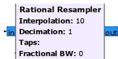
Abbildung 31 Resampler Block
