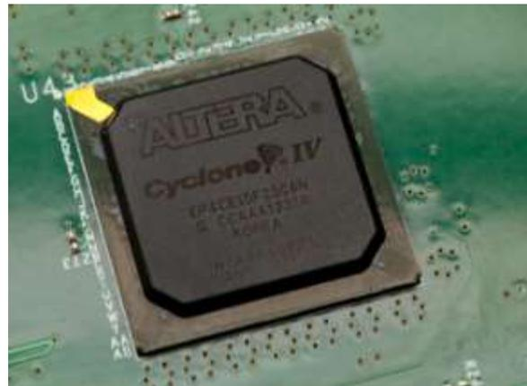
Abbildung 3 Altera Cyclone FPGA [4]
