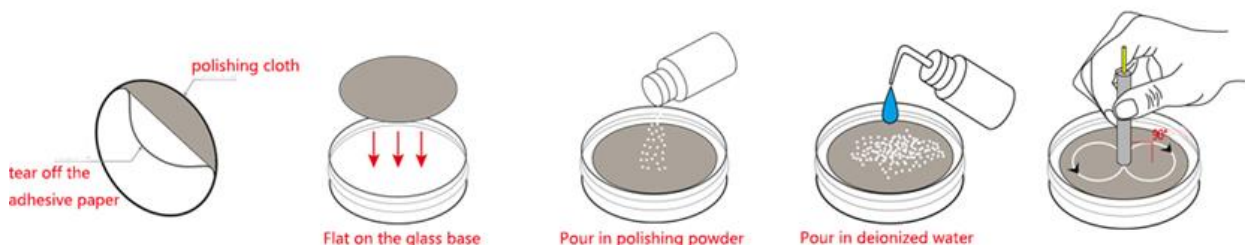
Abbildung 16: Poliervorgang für die RDE nach [60]
