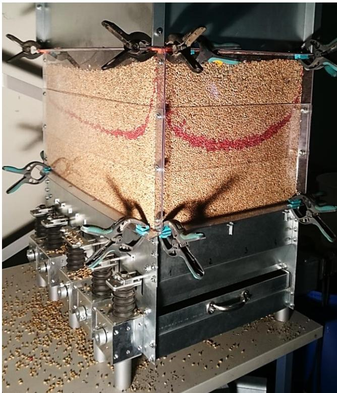
Anlage 16: Voruntersuchung von Fließprofilen oberhalb der neuartigen Austrageinrichtung
