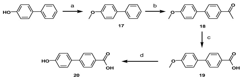
**Scheme 3.7** Synthesis of the 4-(4-hydroxyphenyl)-benzoic acid (**20**) (a)  $\text{CH}_3\text{I}$ ,  $\text{NaOH}$ ,  $\text{EtOH}/\text{water}$ , reflux, 84 %, (b)  $\text{CH}_3\text{COCl}$ ,  $\text{AlCl}_3$ ,  $\text{CH}_2\text{Cl}_2$ , ice-bath $\rightarrow$ reflux, 43 %, (c)  $\text{Br}_2$ ,  $\text{NaOH}$ , 1,4-dioxane/water, ice-bath $\rightarrow$ RT, 90 %, (d)  $\text{CH}_3\text{COOH}$ , 48 %  $\text{HBr}$ , reflux, 91 %.
