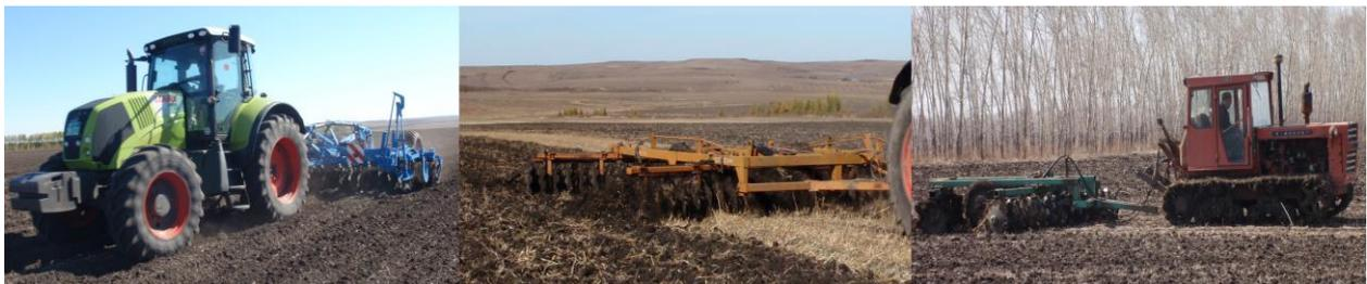
Abbildung 7: Arbeitsgeräte im Arbeitsverfahren Bodenbearbeitung – Scheibeneggen
