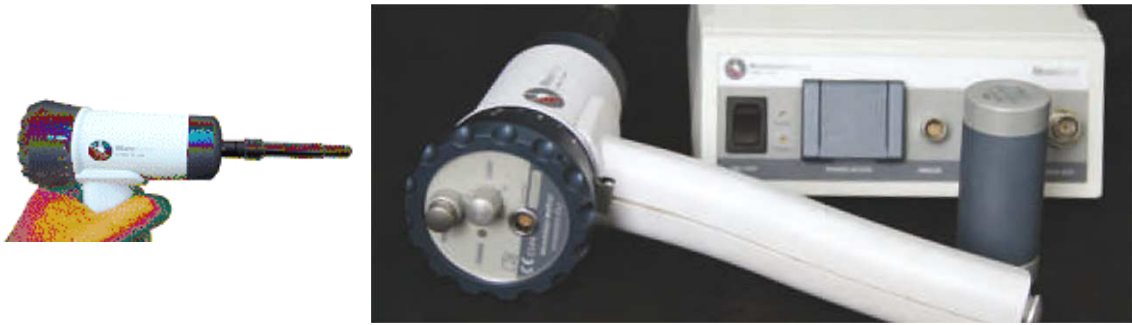
Abbildung 4: Aufnahmekopf und Zentraleinheit des SDF-Gefäßmikroskops der Firma MicroVisionMedical [123].
