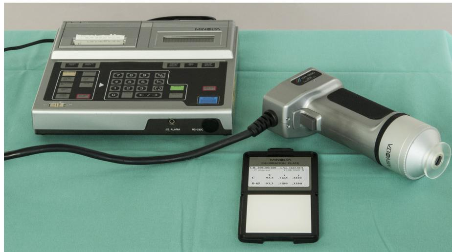
Abb. 7: Das Chroma Meter CR-200 (Minolta, Osaka, Japan)
