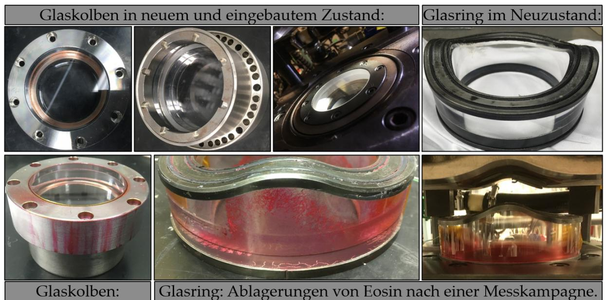
Abbildung A.15: Glasbauteile im Neuzustand und nach einem Experiment.
