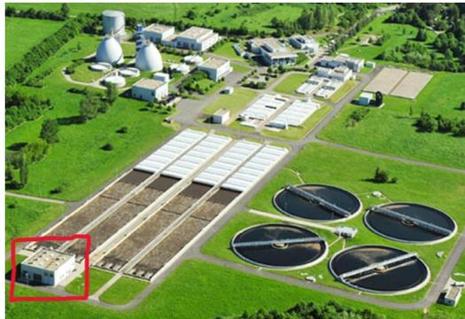
Abb. 2: Übersicht der Kläranlage Halle-Nord (vor 2017) mit der Gebläsestation am Ende der Belebungs-becken (rot eingerahmt). [22]
