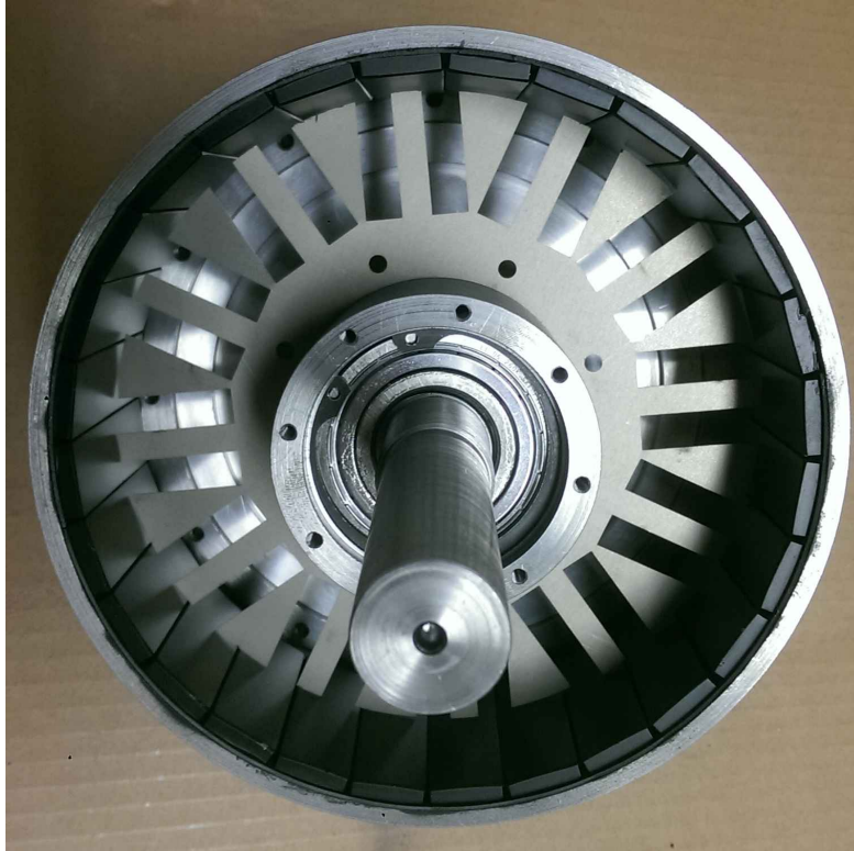
Abbildung 7.6 – Welle mit montierten Rotor und Statorblech
