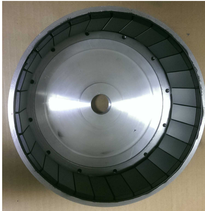
Abbildung 5.6 – 28 poliger Rotor der entworfenen Maschine
