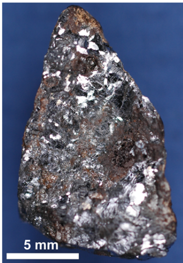
Abb. 16.1.1: Galeniterzfragment 12/5001/12/4 mit feinen Eisenhydroxidmassen.
