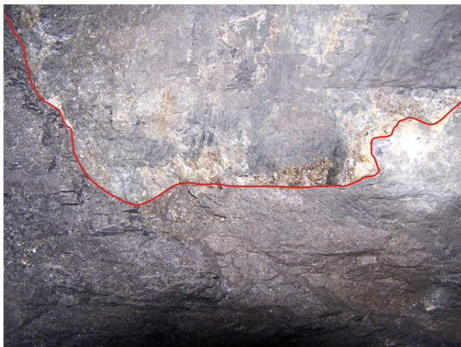
Abb. 14.1.3: Untertage aufgeschlossener Sphaleriterzkörper bei Saryyurt (unter der roten Markierung). Am scharfen Übergang zum Nebengestein finden sich partiell Ansammlungen von massivem Pyrrhotin und Pyrit (Bildhöhe etwa 4 m).
