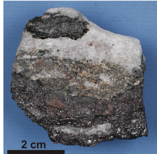
Abb. 14.1.9: Probe Sare-03. Massive Sphaleritlage mit scharfem Übergang zum Nebengestein (überwiegend Quarz).
