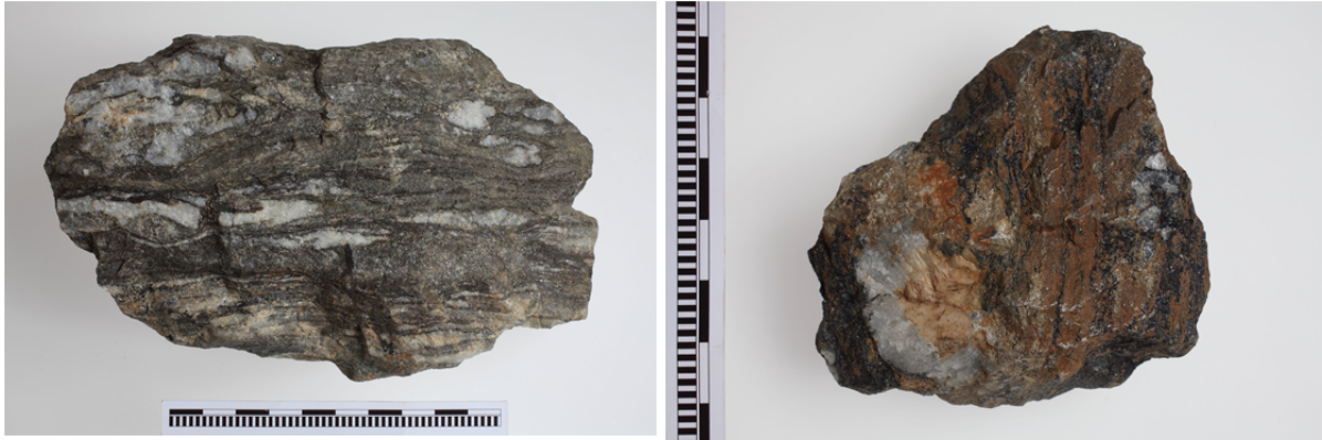
Abb. 14.1.16: Kalkschiefer mit stratiformen Erzlagen aus
