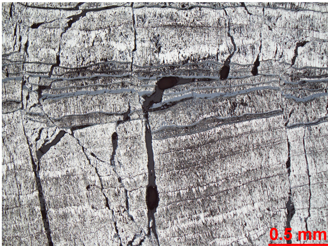
Abb. 14.1.24: Probe Nif-01 im Auflicht. Kataklastisch zerrütteter Pyrit (weißlich-gelb), der entlang von Bruchstrukturen von Eisenhydroxiden (hellgrau) sowie von Quarz bzw. Baryt verdrängt wird. Markasit (feinste, schmutzig graue Gemenge auf den Pyritaggregaten) verdrängt flächig den Pyrit.
