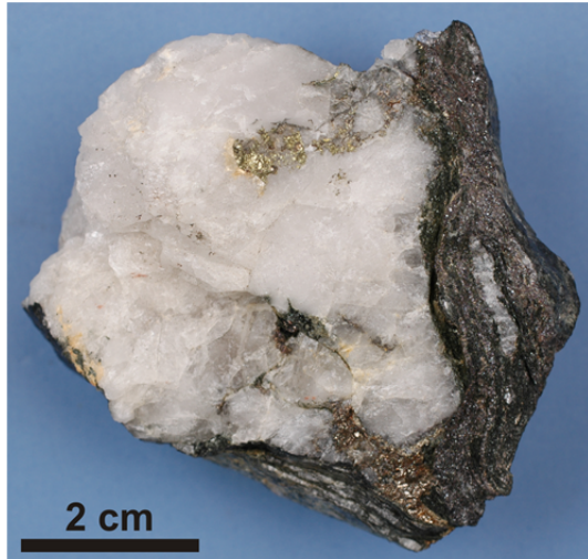
Abb. 14.1.8: Probe Sare-01. Quarzmobilisat umgeben von einer feinkristallinen, aber massiven Sphaleritvererzung. Pyrit (hellgelb glänzend) wächst in den Quarz hinein und ein Pyrrhotinaggregat (rostbraun metallisch glänzend, unten rechts) befindet sich im Druckschatten des Quarzmobilisates.
