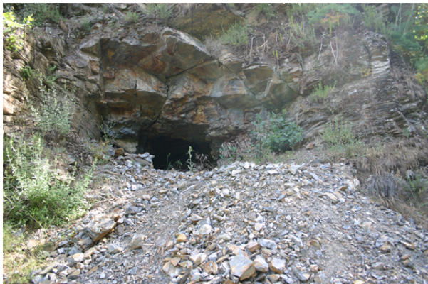
Abb. 14.1.6: Begonnener Stollenvortrieb bei Maden Tarla (Südseite) der etwa 10 m höher liegt, als die Stollen in der Abbildung 14.1.5. Schmale, aber massive Galenitlagen sind hier aufgeschlossen (Abb. 14.1.7).
