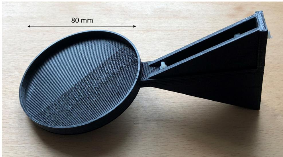
Abb. 5.50: Tischsystem als Probenauflage zur Fixierung an der Linearführung; Kunststoff-3D-Druck
