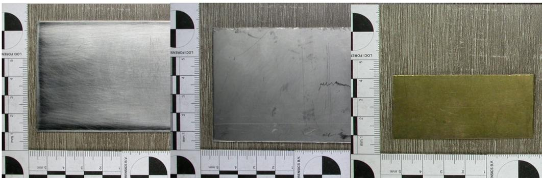
Abb. 5.54: Übersicht über die mittels Prototyp analysierten Blechmaterialien vorab unbekannter Zusammensetzung; die Proben wurden im Prototypen auf dem Probenstisch positioniert und hinsichtlich ihrer Elementzusammensetzung analysiert
