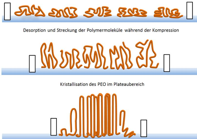
**Abbildung 3-12** Der Zustand der PEO-Ketten bei verschiedenen Kompression ist schematisch dargestellt. Es erfolgt eine Streckung der Ketten bis eine Konformation vorliegt, die dem kristallinen Zustand entspricht und es zur Kristallisation kommt.
