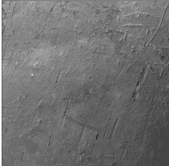
Abb. 24: Rasterelektronenmikroskopische Darstellung der Oberfläche nach Vorbehandlung mit Schleifpapier der Körnung 800, 30 sekundiger Ätzzeit in zwanzigfacher Vergrößerung
