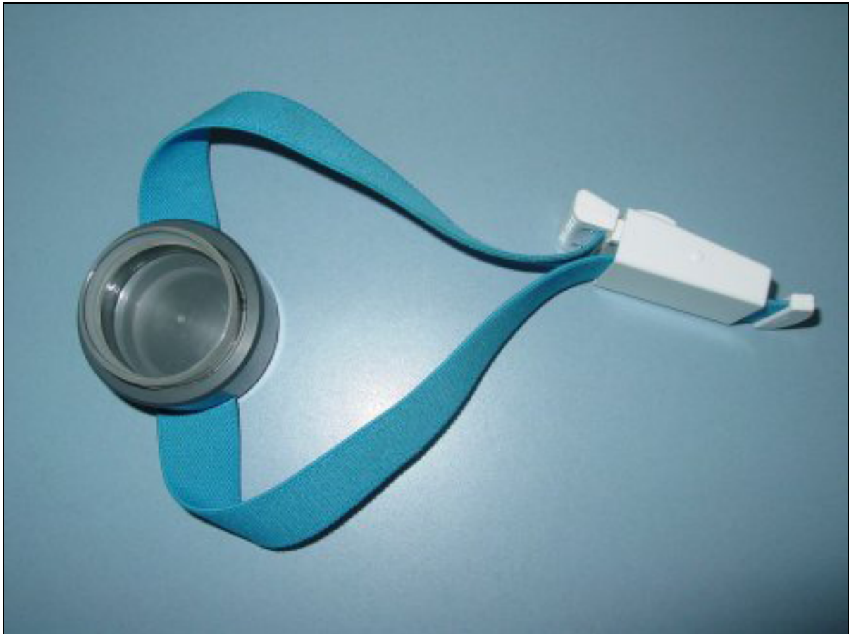
Abb. 5: Extraktionsgerät für die in vivo-Oberflächenextraktion [57]
