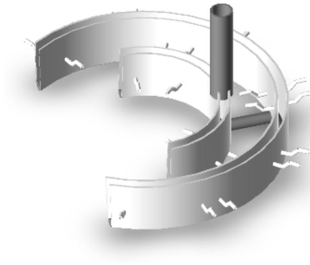
Abbildung A-3 Lösungsmittelverteiler T-Anlage
