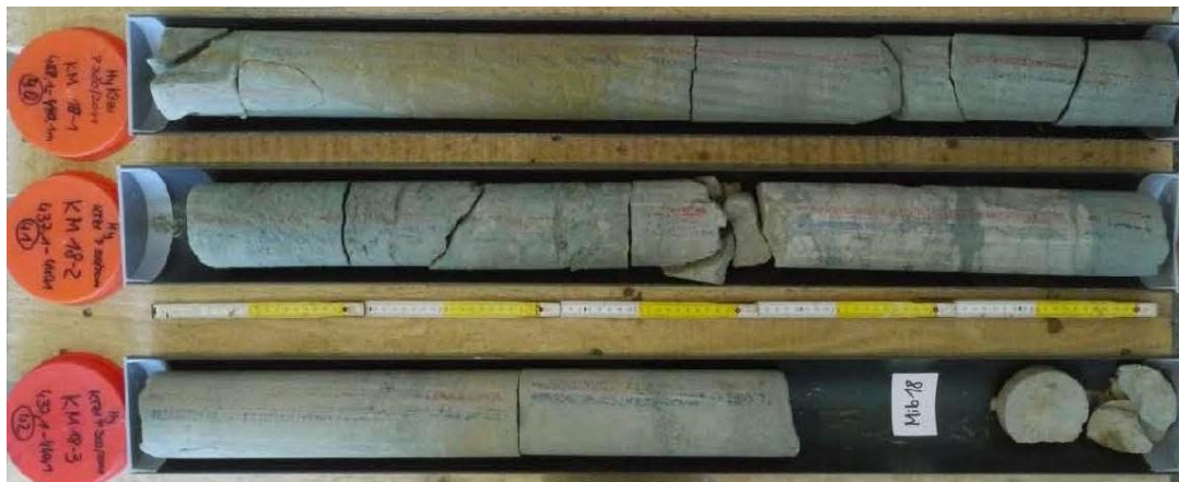
Abb. 3.2: (oben) Exemplarische Kernmärsche der Bohrungen Ktzi 203 (Reservoirsandstein der Stuttgart-Formation, gelb: Probenplatzhalter) und (unten) P300 (Mergel- und Sandstein der Exter-Formation) (modifiziert nach Norden & Klapperer, 2011 und Norden, 2012).
