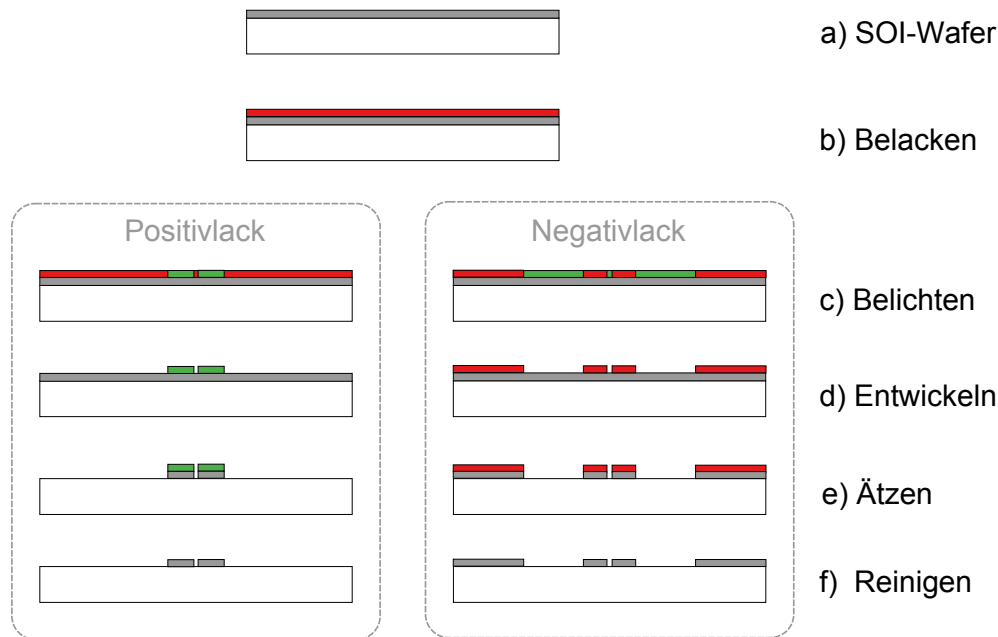
Abbildung 5.7. Schematische Darstellung des Ätzprozesses zur Herstellung von SOI-Wellenleitern. Ausgangspunkt ist ein handelsüblicher SOI-Wafer a). (Zur besseren Übersicht wurde der Substratwafer in allen Zeichnungen ausgelassen.) Der Wafer wird mit Hilfe einer Lackschleuder mit Photolack beschichtet b). Dieser wird mittels Elektronenstrahlithographie belichtet c). Anschließend wird der Lack entwickelt und die Struktur mittels RIE-Ätzen 29 in die Siliziumschicht übertragen e). Abschließend wird der verbliebene Lack nasschemisch entfernt f).
