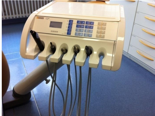
Abb. 5: Dentalinstrumente (von links nach rechts: Luft-Wasser-Spray, Turbine, Mikromotor links und rechts, Zahnsteinentfernungsgerät)
