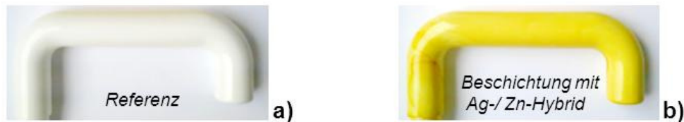
Abbildung 5.49: Türklinke mit U1C-Beschichtung (a) und mit einer antimikrobiell modifizierten U1C-Beschichtung (15 % PEIm0,5C16 Ag(0) / 15 % PEIm0,5C16-Zn(II)) (b).
