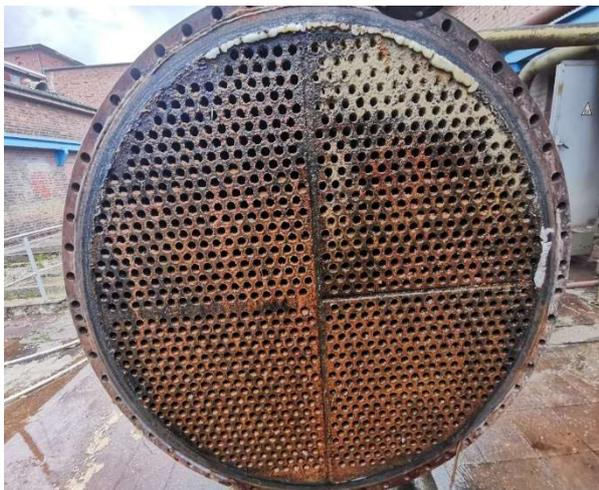
Abb. 17: Jetziger Zustand des Kühlers 15 mit Verstopfung und Korrosion.
