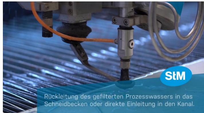
Abb. 8: ein automatisches, platzsparendes Abrasiv-Ausspülsystem
