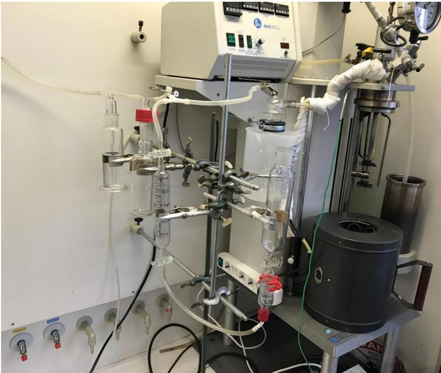
**Abbildung 13:** Versuchsaufbau in der Hochschule Merseburg; rechts: Rührreaktor mit Umhängeheizung; links: Weg des Gases durch den Kondensator, die Spülflaschen und die Gasmaus (2)
