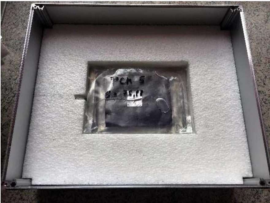
Abbildung 23: fertige Probe in PA/PP Folie mit Thermoelement im 3-Schicht-Kalorimeter (13)
