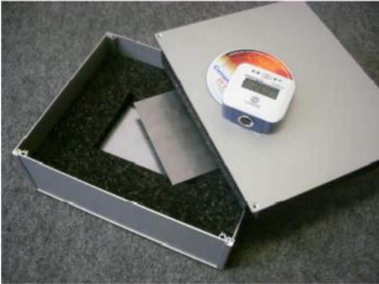
Abbildung 22: 3-Schicht-Kalorimeter (13)
