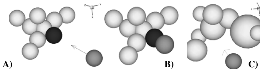
Abbildung 3.3: A) Primärpartikel (der Vektor zeigt die Relativgeschwindigkeit zwischen Partikel und Agglomerat) das mit einem Agglomerat kollidiert. Das schwarze Partikel wurde als Stoßpartner ermittelt. B) Agglomerat nach Anhaften des neuen Partikels (dunkel grau) am Kollisionspartner (schwarz). C) Primärpartikel (dunkel) fliegt durch die Agglomeratstruktur und führt keinen Stoß aus.
