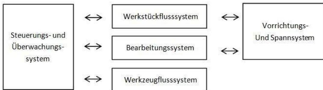
**Abb.4: Elemente eines FFS und deren Wechselwirkungen**
