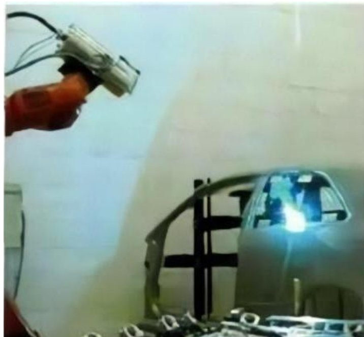
Laser-Remote-Schweißen der Heckfensterbank der Karosserie
