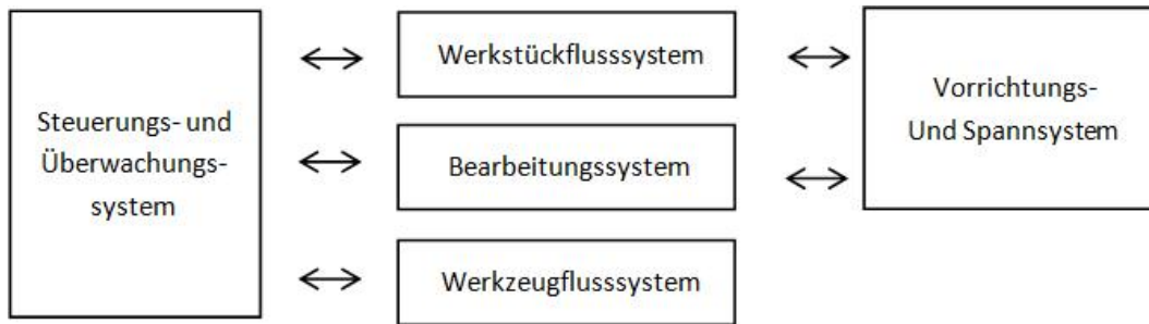
Abb 4: Elemente eines FFS und deren Wechselwirkungen[1]
