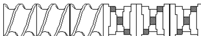
Abbildung 29: Kombination von Förder- und Knetelementen für die dynamische Vulkanisation, Kombination wiederholt sich viermal
