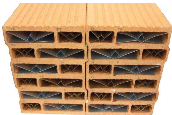
Bild 83: Probekörper aus Ziegelsorte C für die Halbsteinmessung. Die eingebrachten Stecklinge bestehen aus beschichtetem Karton („ Aluminiumpaste Blitz Maxal 66012 SI/70 BG “ und „ Goldbronzepulver Luminor 2210 “). Der Emissionskoeffizient des beschichteten Kartons beträgt jeweils \varepsilon = 0,50 für beide Pigmente
