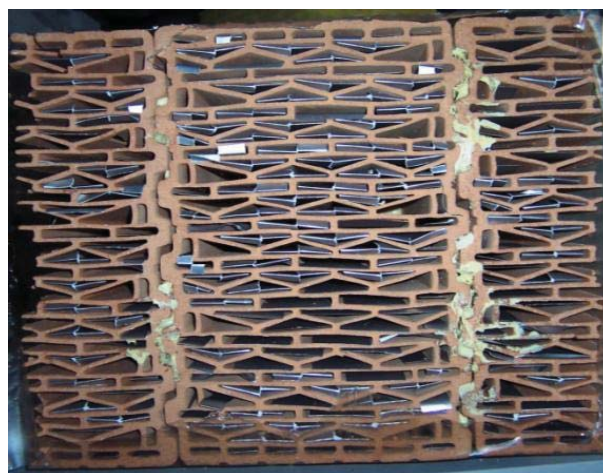
Bild 84: Probekörper aus Ziegelsorte B für die Halbsteinmessung. Die eingebrachten Stecklinge bestehen aus beschichtetem Karton (Aluminiumpaste „Blitz Maxal 66012 SI/70 BG“) ausgestattet. Der Emissionskoeffizient des beschichteten Kartons beträgt \varepsilon = 0,50
