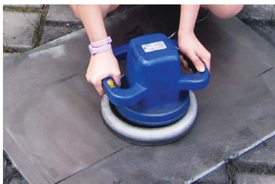
Bild 81: Polieren einer Graphitschicht auf einem Kartonträger. Die Beschichtung aus 3 Vol.-% Graphit und 97 Vol.-% verdünntem Holzleim (1 Teil Holzleim : 4 Teile dest. Wasser) wurde mittels Airbrush-Technik aufgesprüht. Nach dem Poliervorgang betrug der Emissionskoeffizient des graphitbeschichteten Kartons \epsilon = 0,46
