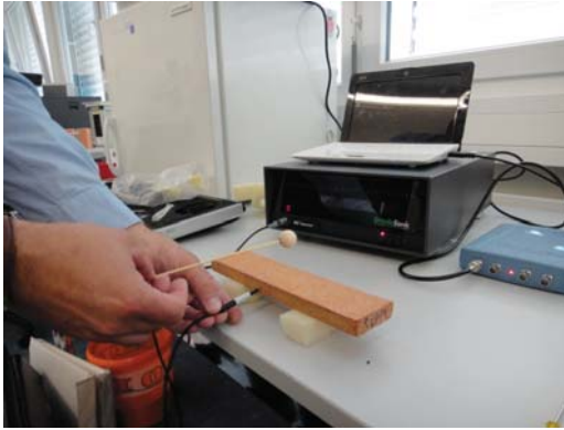
Bild 85: Anregung einer Biegeschwingung durch Anschlagen mit einem geeigneten Werkzeug und gleichzeitige Erfassung der Schwingung mittels Piezotaster
