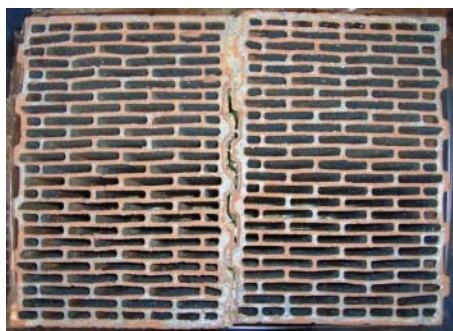
Bild 79: Beschichteter Probekörper aus Ziegelsorte A
