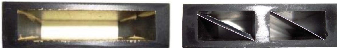
Bild 99: Modellziegel 1 mit einer Beschichtung aus Pigment „Goldbronzepulver Luminor 2210“ der in Wärmestromrichtung gegenüber liegenden Strahlungsflächen (Links) und Modellziegel 2 mit Schirmchen aus metallisiertem Papier (rechts)
