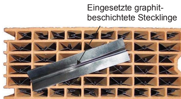
Bild 82: Ziegel G mit beschichteten Stecklingen (Graphitbeschichtet und poliert) in den Löchern. Der Emissionskoeffizient des graphitbeschichteten Kartons beträgt \epsilon = 0,46
