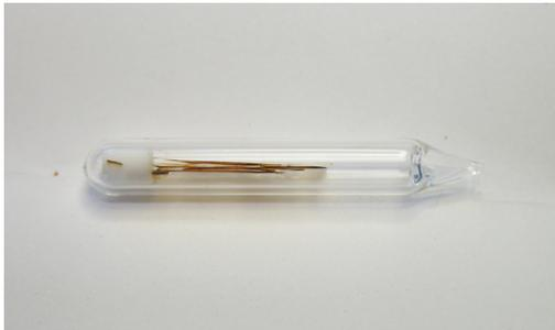
(c) Orientierte Probe für winkelabhängige MQ Messungen
