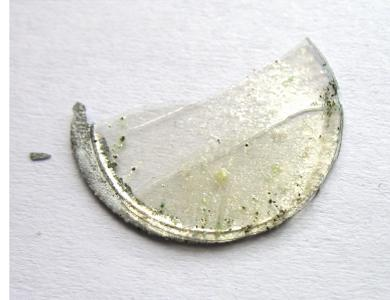
(d) AAO Membran mit infiltriertem Polymer und weggeätztem Boden
