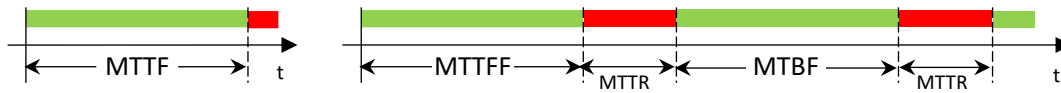
Bild 2.4: Grafische Beschreibung der Begriffe MTTF, MTTFF, MTBF und MTTR (vgl. [21]): Abgebildet ist links die nicht reparierbare Einheit mit ausschließlich einer Mean-Time-To-Failure (MTTF). Rechts ist die reparierbare Einheit dargestellt, welche durch eine Mean-Time-To-First-Failure (MTTFF), Mean-Time-To-Repair (MTTR) und künftig durch eine Mean-Time-Between-Failure (MTBF) charakterisiert wird.
