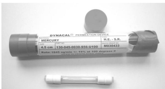
Abb. 3.4 Quecksilber-Permeationsgerät MKAL der Fa. Breitfuss und Permeationsröhrchen der Fa. DYNACAL®
