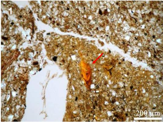
HOLZ, 1. Horizont (2–5 cm): PPL tonreiches Aggregat mit mikrolaminiertem Toncutanbruchstück (Pfeil)
