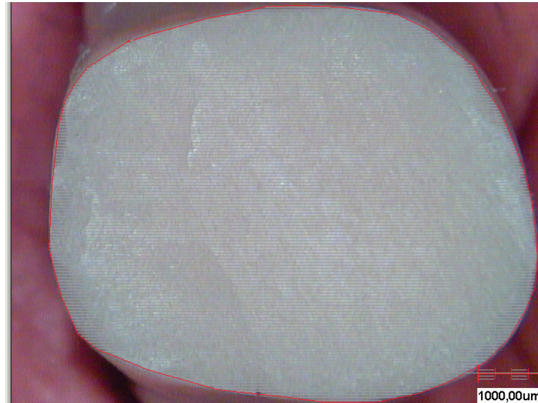
Abbildung 5: Basis des Kunststoffzahnes im Mikroskopbild mit Messraster
