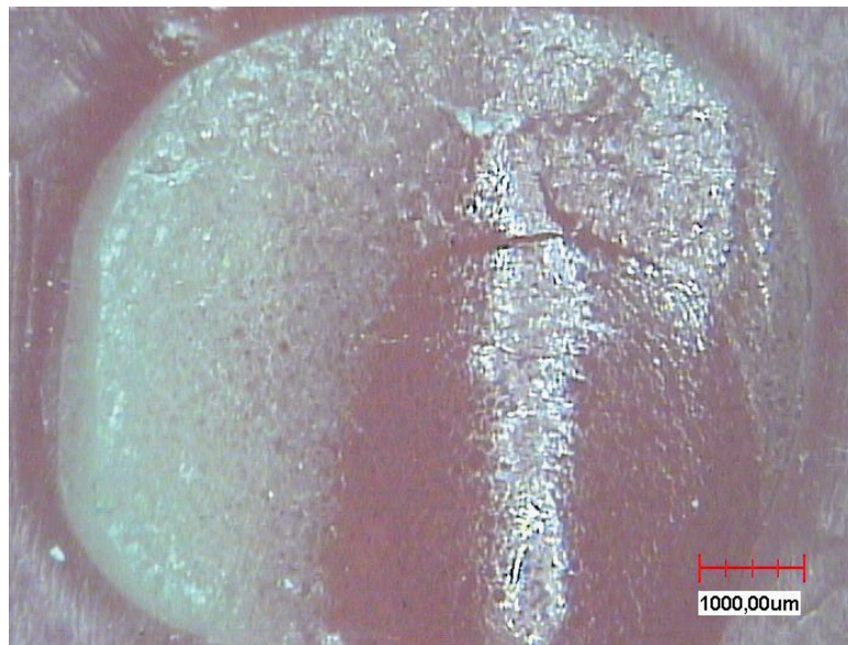
Abbildung 13: Bruchfläche zwischen Vita-Zahn und Paladon®65 mit Haftvermittler (kombiniert adhäsiver und kohäsiver Bruch)
