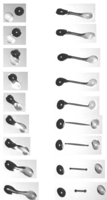
a) Kollision mit anschließender Separation; \Delta t = 100 \mu\text{s} .
