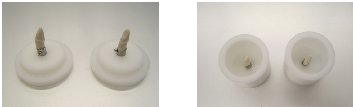
Abb. 7 Dublierformen 1 (Material: POM) mit präparierten Ur-Stümpfen (ZMG-F)
