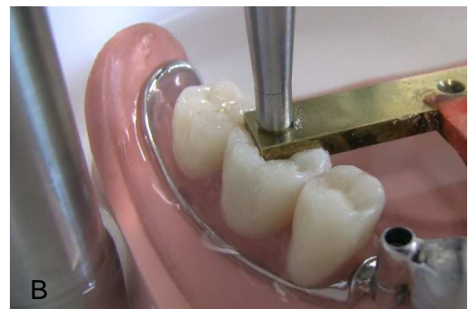
Abb. 11 A-Messing-T-Kreuz mit Haken; B-Stempel mit Gewinde am Messing-T-Kreuz
