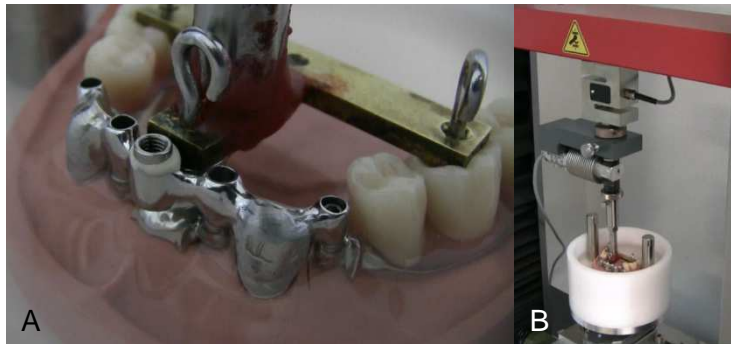
Abb. 17 A-Ein- und Ausgliederungsversuche Z010 B-Prüfapparatur Universalprüfmaschine Z010
