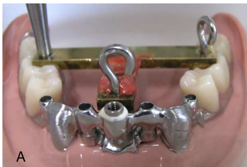
Abb. 12 A und B-Stempelbelastung-Kausimulation
