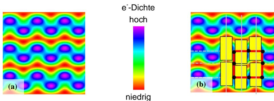
**Abb. 4.19:** (a) Elektronendichteverteilung in der Col<sub>rec</sub>/p2mg-Phase von Verbindung **D.O22-BzO8**; (b) mit Modell der Anordnung der Bänder (schwarze Punkte = Zentrum einer 2-zähligen Rotation, graue Striche: durchgezogen = Spiegelachse, gestrichelt = Gleitspiegelachse)
