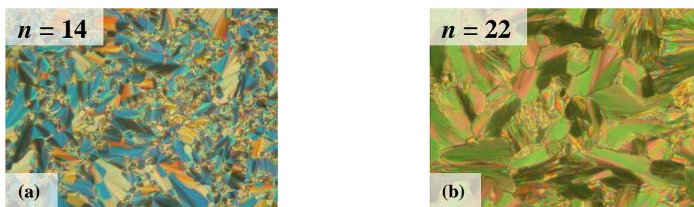
**Abb. 4.27:** Texturen zwischen gekreuzten Polarisatoren: (a) der  $Sm\tilde{A}$ -Phase von **D.O14-Ter8** bei 123 °C; (b) Mosaiktextur der  $Col_{ob}$ -Phase von **D.O22-Ter8** bei 134 °C
