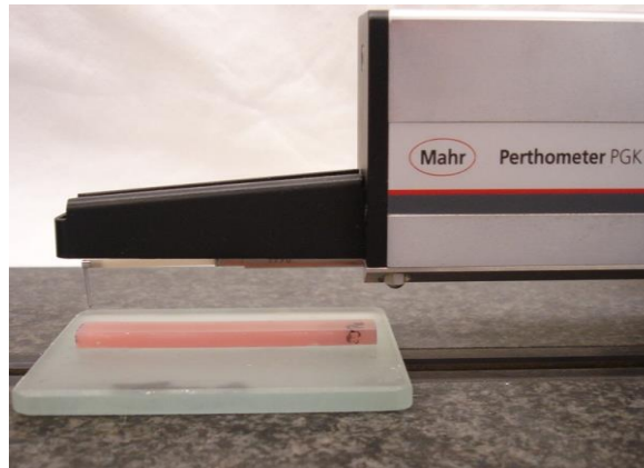
Abb. 7 Rauheitsmessgerätes Perthometer S3P (Feinprüf-Perthen GmbH, Göttingen, Deutschland) mit einem Prüfkörper Forestacryl-rosa
