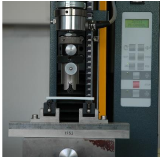
Abb. 6 Universalprüfmaschine Zwick I (1120) mit Drei-Punkt-Biegeeinrichtung und Prüfkörper aus Forestacryl-klar (Zwick, Ulm, Deutschland)
