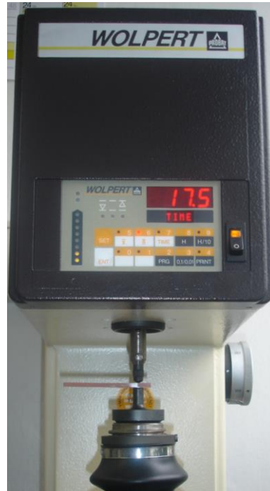
Abb. 4 Instron-Wolpert-Makrohärte K-Testor 2524 (Instron-Wolpert, Darmstadt, D) mit Prüfkörper Forestacryl-rosa
