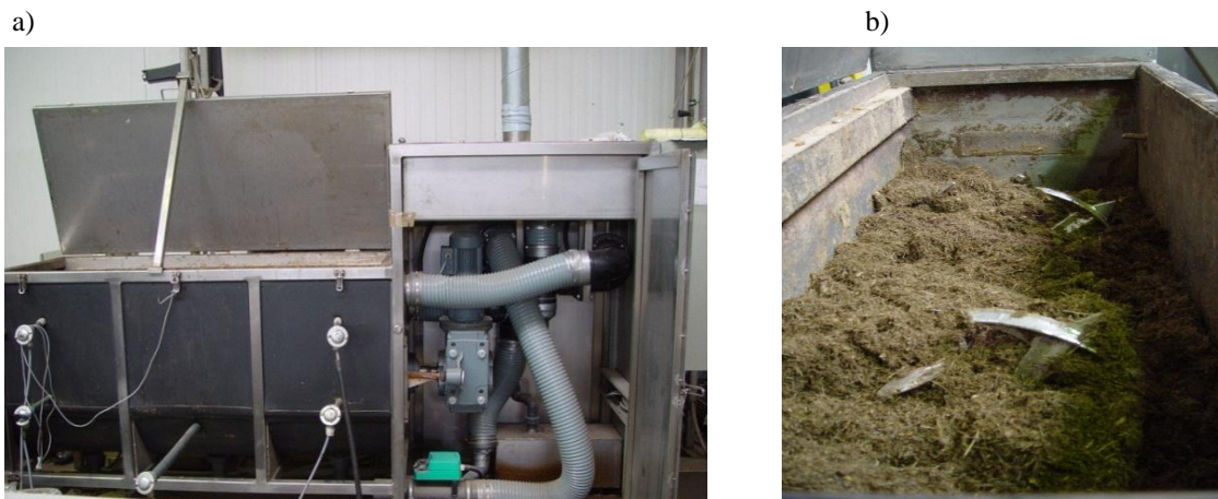
Abbildung 3: Reaktor A (BioSal Anlagenbau GmbH, Bad Lausick). Komplettansicht (a) und Innenansicht (b). Um eine optimale Durchmischung des Materials zu gewährleisten, wurde eine rotierende Welle eingesetzt (b) und an drei unterschiedlichen Stellen Probenmaterial entnommen und vermischt. Die Temperatur wurde sowohl automatisch jeweils an den beiden Reaktorlängsseiten und in der Mitte sowie per Hand mit einer Messsonde bestimmt.
