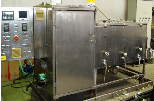
Abbildung 4: Reaktor B (BioSal Anlagenbau GmbH, Bad Lausick) als Komplettansicht. Für eine optimale Durchmischung des Materials wurde eine rotierende Welle eingesetzt. Die Temperatur wurde sowohl automatisch an den Wellen, links und rechts vom Reaktor und per Hand mit einer Messsonde bestimmt.
