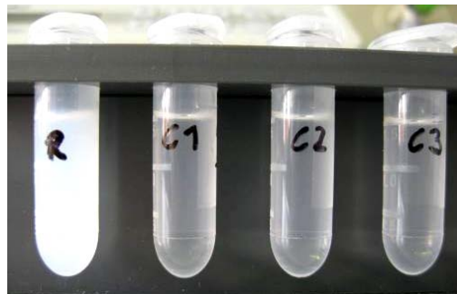
Abbildung 3-9: Optische Darstellung des Reaktionsansatzes (R) aus Z-Gln-Gly, Octylamin und MTG Activa ® WM nach 120 min bei 37 °C im Vergleich zu Kontrollreaktionen (C). Reaktionsansatz (R) aus Z-Gln-Gly und Octylamin (Verhältnis 1:1) wurde mit MTG Activa ® WM versetzt und 120 min bei 37 °C inkubiert. C1: Z-Gln-Gly + MTG Activa ® WM; C2: Octylamin + Z-Gln-Gly; C3: Octylamin + MTG Activa ® WM. MTG...mikrobielle Transglutaminase.
