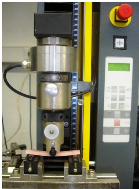
**Abb. 9:** Drei-Punkt-Biegeeinrichtung an der Universalprüfmaschine ZWICKI TMZW (Zwick GmbH & Co. KG, Ulm, Deutschland)
