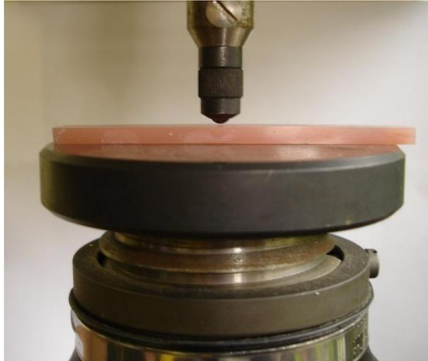
**Abb. 10:** Instron Wolpert-Makrohärte K-Testor 2524 mit Kunststoffprüfkörper (Wolpert Wilson Instruments, Pfungstadt, Deutschland)
