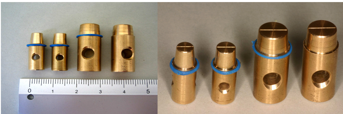
Abb.7: Messingpfeiler 34, 44 und 37 mit angelegten Gummiringen zur Simulation des Sulcus gingivalis bei der Modellherstellung
