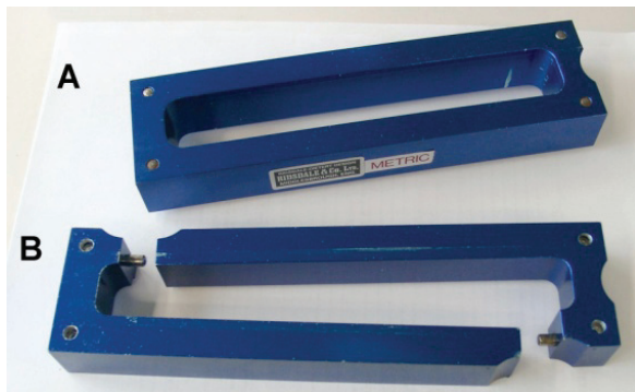
Abbildung 2-2: Mehrfach teilbare Prüfkörperform für die Herstellung von Biegeiegeln aus Aluminium (obere Formhälfte (A) und untere, ebenfalls teilbare Formhälfte (B)).
