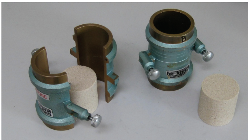
Abbildung 2-4: Teilbare zylindrische Form für die (Druck-) Prüfkörperherstellung aus Messing; rechts unten: Prüfkörper aus proteingebundenem Sand für den Druckversuch (Höhe: 50 mm, Durchmesser 50 mm)
