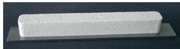
Abbildung 2-3: Prüfkörper für den Biegeversuch. Zusammensetzung: Quarzsand mit Caseinat (1,0 % b.o.s.) als Bindemittel
